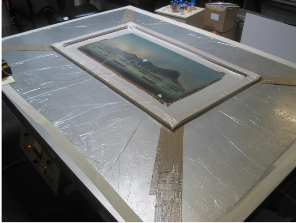
圖 9. 使用加熱抽氣桌為油畫托裱
