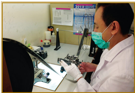
◆ 在進行數碼掃描前，修復人員以影片專用膠紙修補硝酸片《天上人間》（1941）受損的片邊和齒孔
