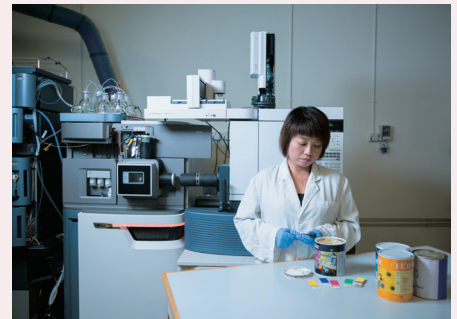
▲ 修復人員正準備油漆樣本，以氣相色譜質譜聯儀測量揮發性氣體的含量和性質。
