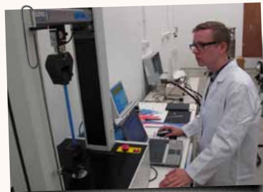
▲ Olli Petteri Peri為加速老化後的合成聚合物進行機械強度測試
